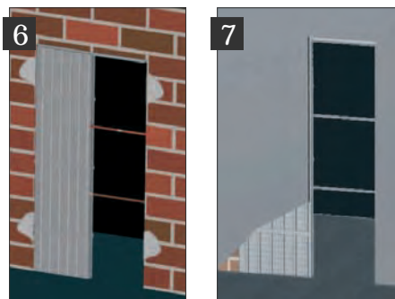
6 Colocar a rede de fibra de vidro fornecida entre o caixilho e a parede para evitar fissuras.
